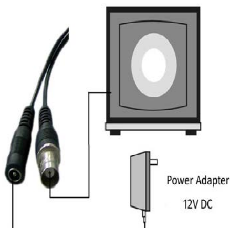
Рис. 6.1.1. Коммутация разъемов видеокамеры
