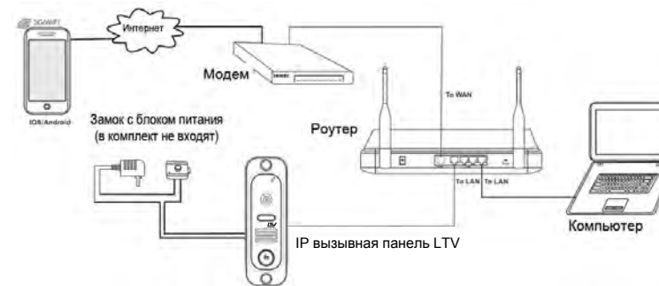
Рисунок 1 – Проводная схема подключения к сети
