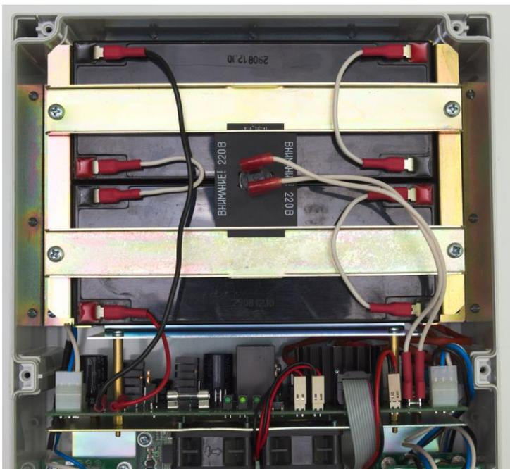
Рис. 2.9.5. Подключение АКБ.
