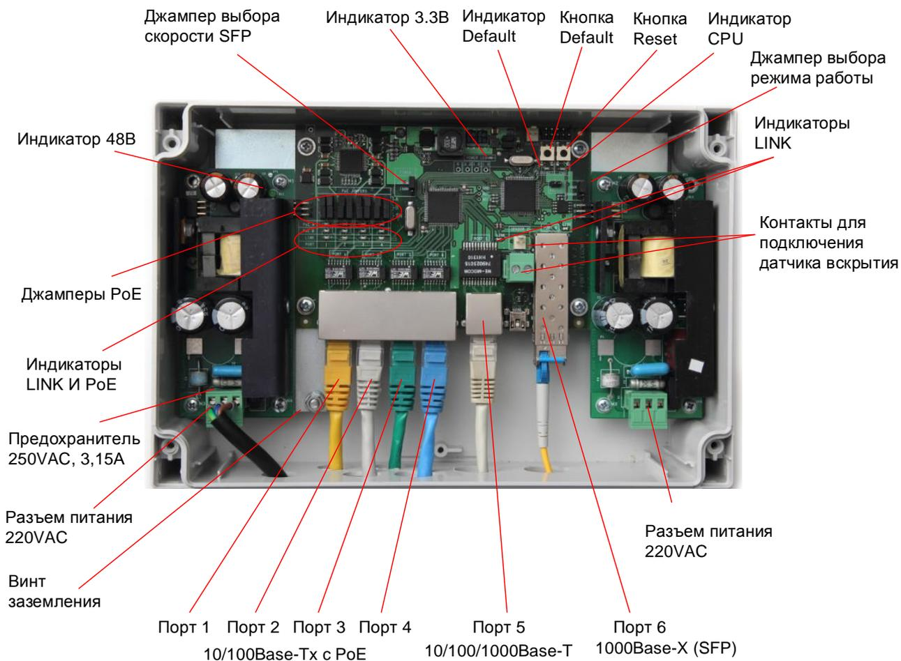
Рис. 2.2-1. Расположение элементов PSW -1G4F
