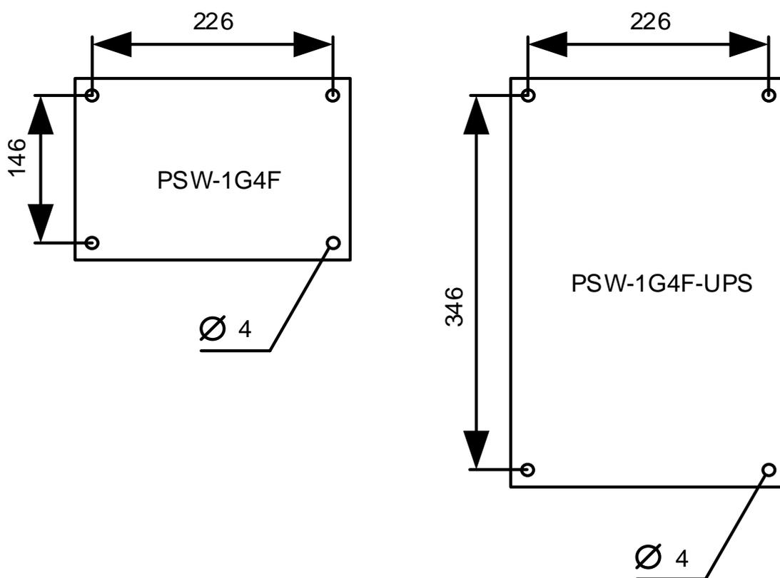
Рис. 6.1.1. Разметка крепления
