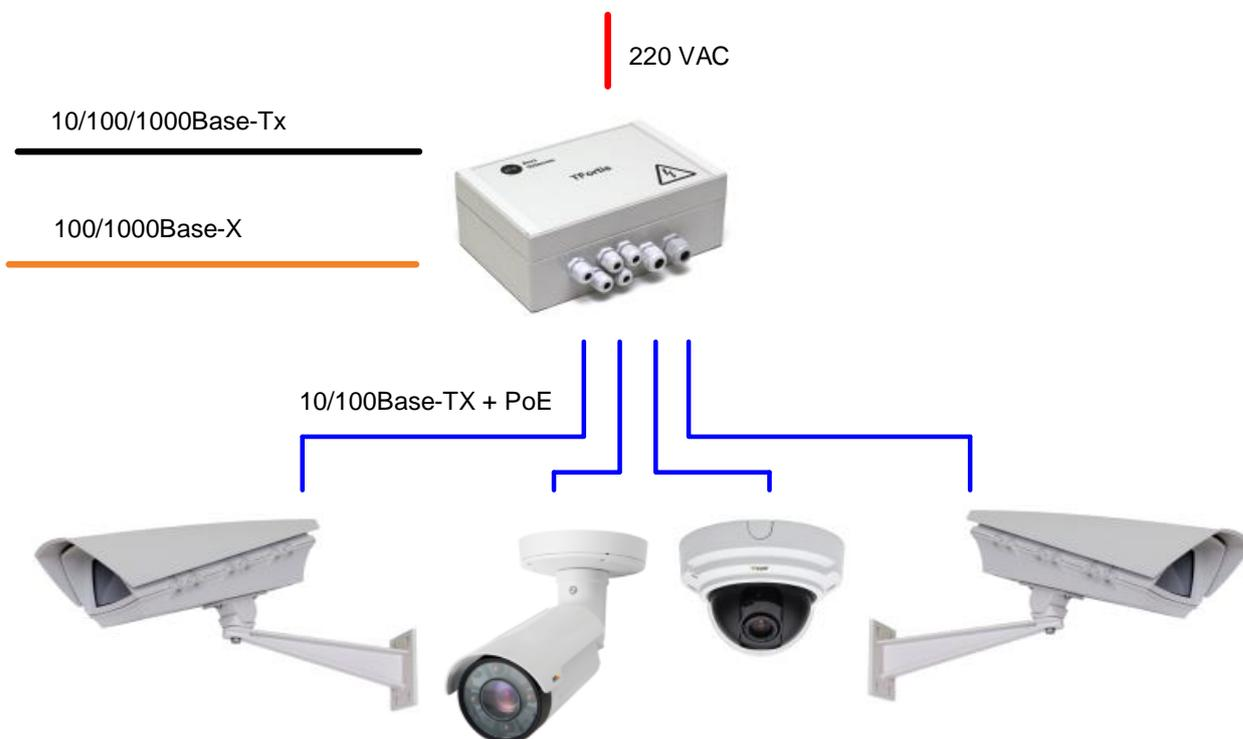
Рис. 1. Схема подключения PSW-1G4F
