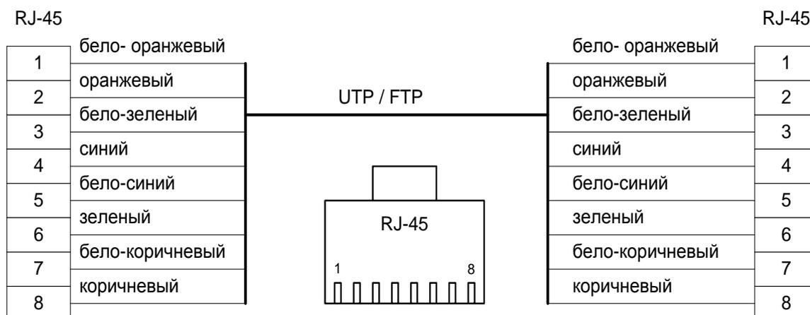
Рис. 6.4. Разделка UTP/FTP кабеля.
